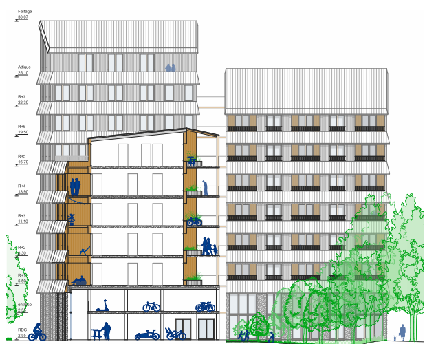
ILOT B8 - GALEO - 2PM A / JBMN architectes - Coupe sur la halle vélo et le jardin
